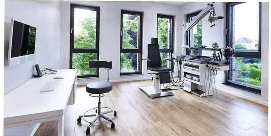
Der elastische, trittschalldämmende »Purline«-Bioboden bringt alles mit, was zur Einhaltung hoher hygienischer Standards nötig ist. Um eine geschlossene Oberfläche zu schaffen, lassen sich die Nähte verschweißen.
